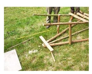
An das obere Ende der Streben wird ein Brett angenagelt – es dient später als Auflage für die Rückenlehne.
